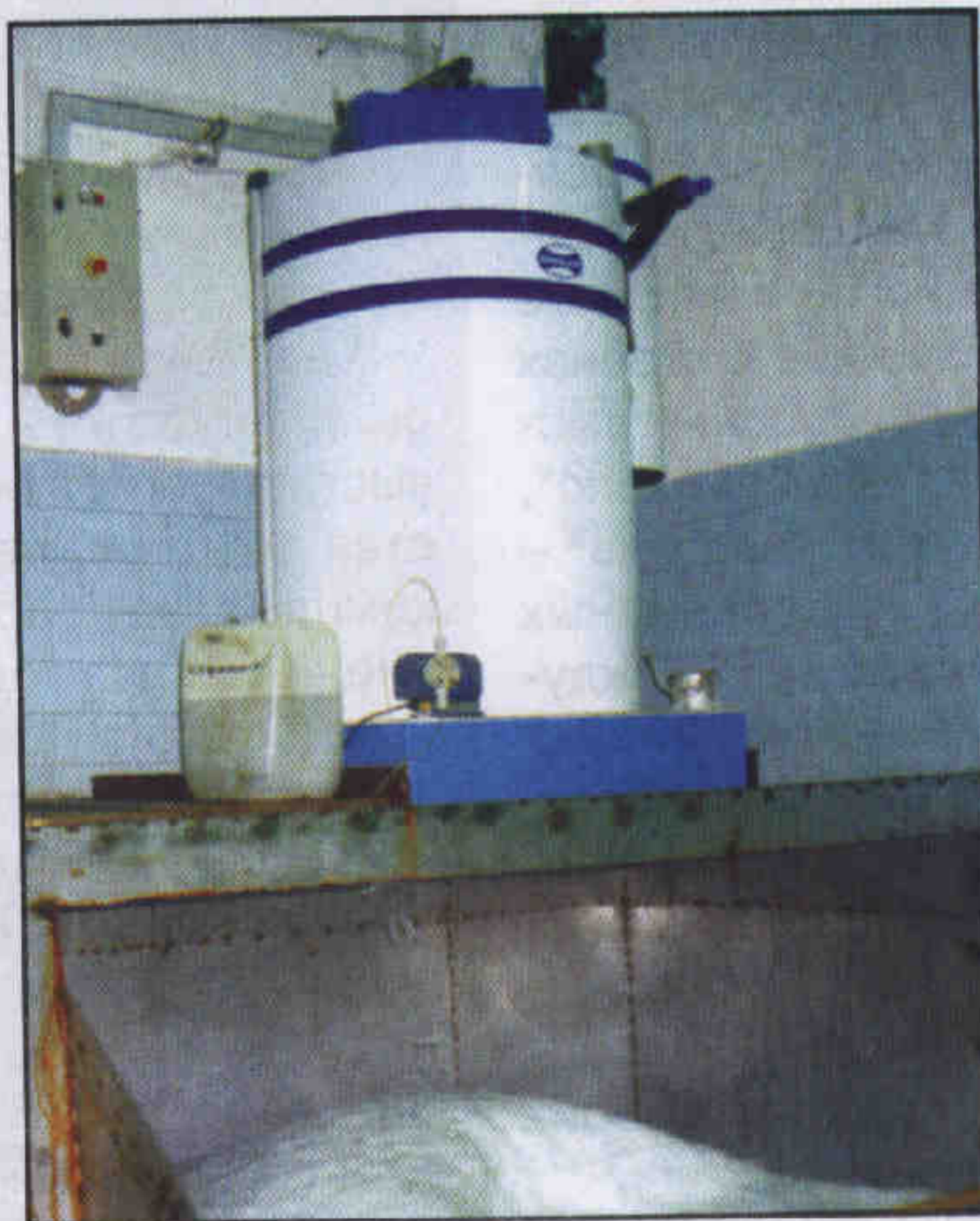
Фреоновый льдогенератор GENEGLACE F600 мощностью 10 т/сут, установленный на Ногинском мясокомбинате. Укомплектован дозирующим насосом для добавления соли
